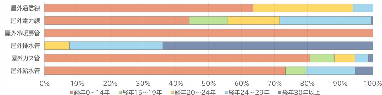
ライフラインのケーブル、配管類は、屋外排水管の老朽化が著しい。また、屋外ガス管、屋外給水管の一部が老朽化している。これらの老朽化した排水管や給水管等は2022年度に更新を予定しており、来年度以降、老朽化の割合は改善するものと思われる。また、屋外通信線、屋外電力線についても40%程度が経年20年を超えており計画的な更新を検討する時期に来ている。
