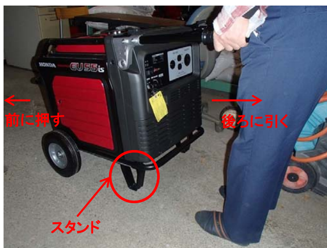
図8 小型発電機移動
