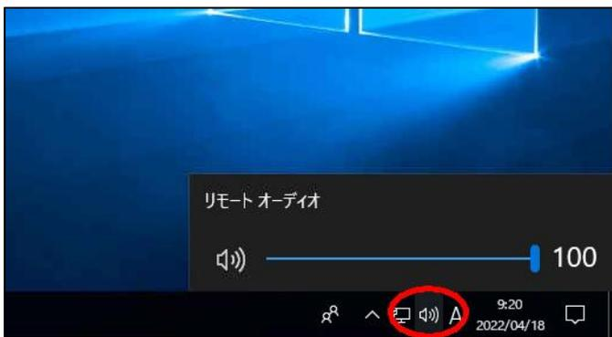
ヘッドフォンや外部スピーカーを接続すると内蔵スピーカーの音はミュートされて、接続されたデバイスから再生されるようになります。ヘッドフォンジャックはディスプレイの背面下にあります。
